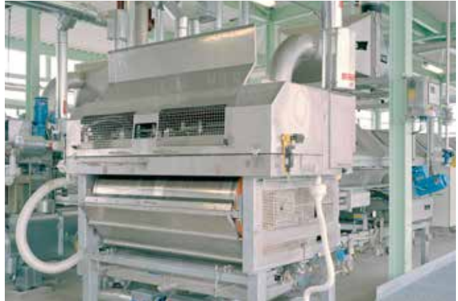
Confectioning – production of Clariant Licocene wax tablets Konfektionierung – Pastillenherstellung der Clariant Licocene Wachs
