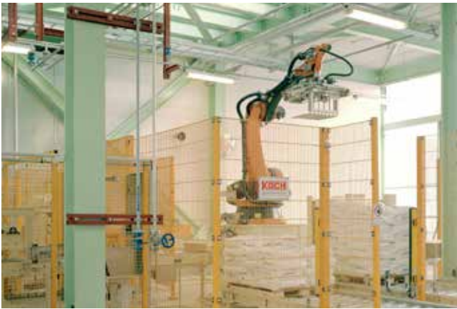
Palettizing robot in Clariant's Licocene wax operations Palettierungsroboter im Clariant Licocene Wachsbetrieb
